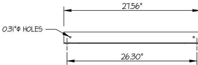
BRACKET SUPPLIED BY SHIMADZU
